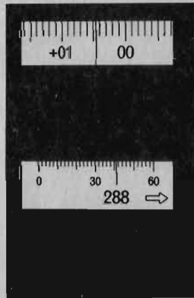
Limbo vertical + 0,0046 360° limbo horizontal con microscopio de escala división dextrorsum 288° 41'
